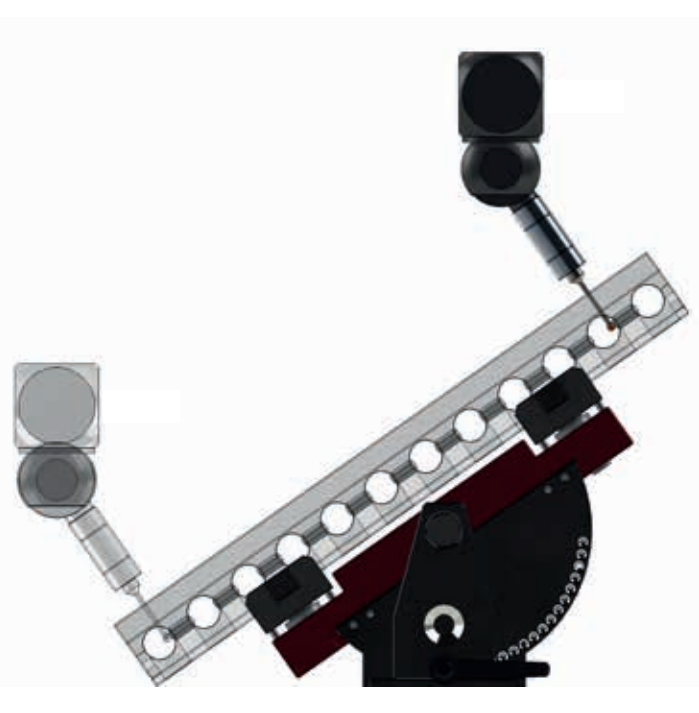
Abbildung 2: unidirektionale Antastung Stufenmaß
