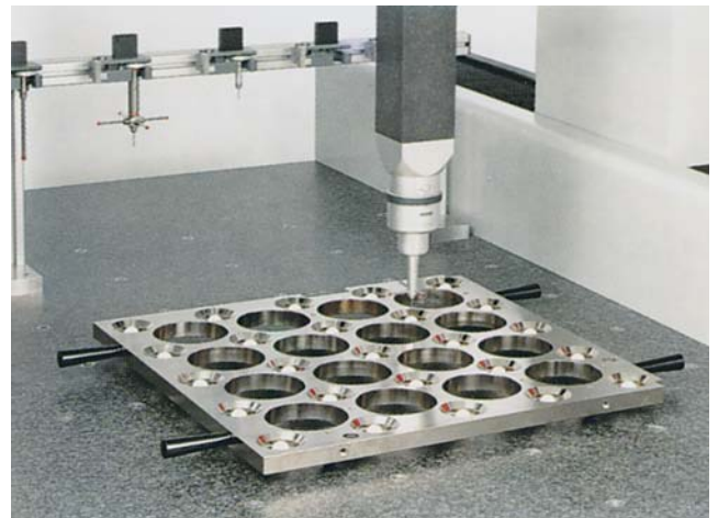
Abb. 4: Kugelplatte KOBA-check 620 horizontal im Einsatz
