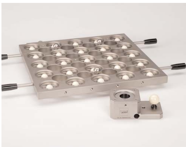
Abb. 1: Kugelplatte KOBA-check im horizontalen Aufbau mit Isoliergriffen und Tasterprüfeinheit
