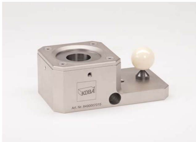
Abb. 2: Tasterprüfeinheit zur Verwendung in horizontaler und vertikaler Lage des Leehringes
