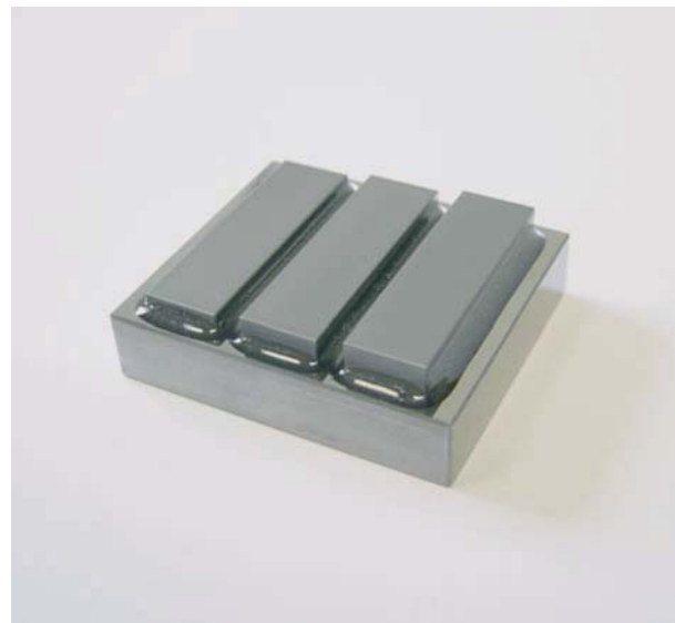
2-Stufennormal mit diffus reflektierenden Messflächen
