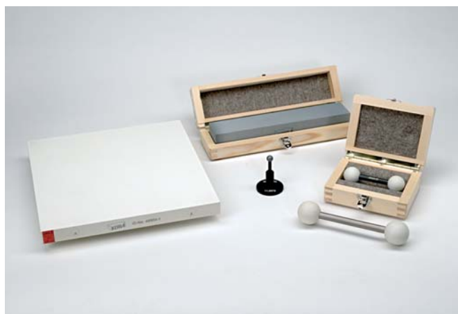
optisch-taktile Normale aus Spezialkeramiken
