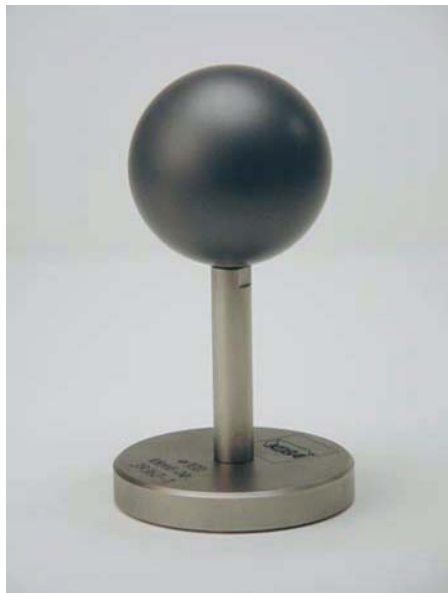
Kugelnormal mit diffus reflektierender Oberfläche
