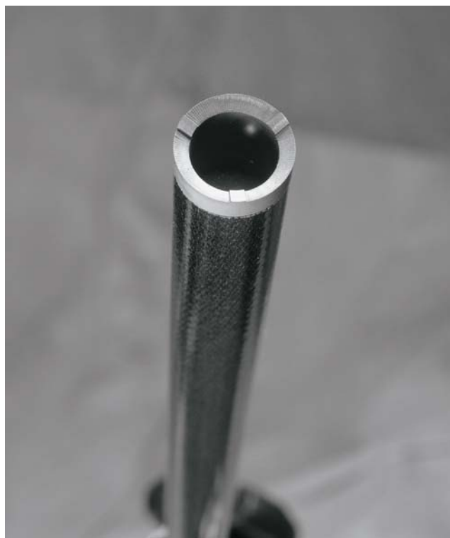
Bild 4: Hartmetall-3-Punktaufgabe in Verbindung mit CFK-Rohr
