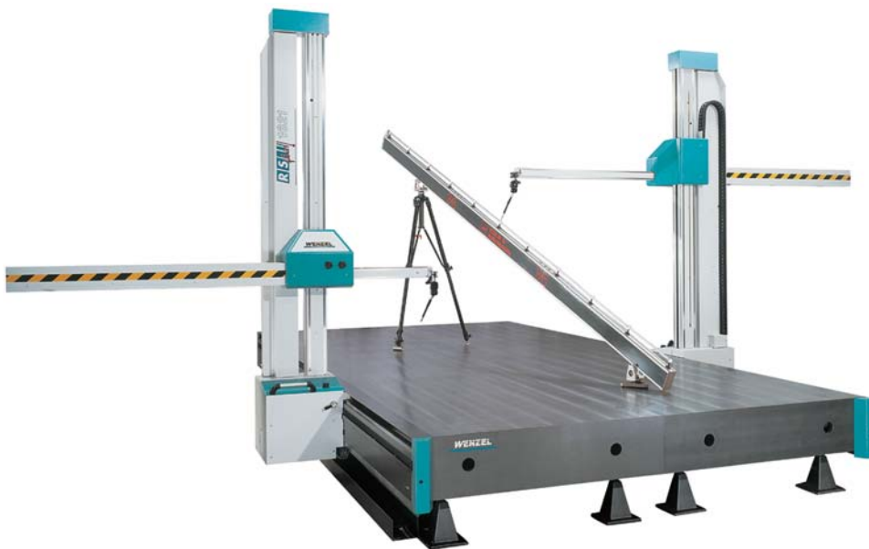
Bild 1: KOBA-Kugelstab auf einem KMG in Ständerbauweise
